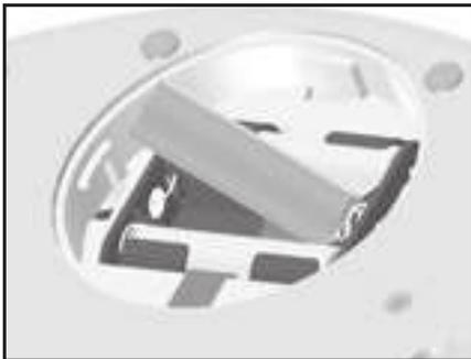
Coloque el hilo rojo antes de insertar la pila.
